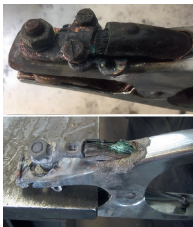
Bild 4. Verschmutzung und lockere Verschraubungen erhöhen den elektrischen Widerstand und führen zu Defekten der Werkstückkontaktierung.
