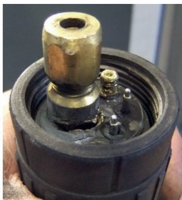
Bild 1. Maschinenseitige (links) und brennerseitige Schmorstellen im Zentralanschluss (rechts; alle Bilder: D. Springhardt, Bergheim)
