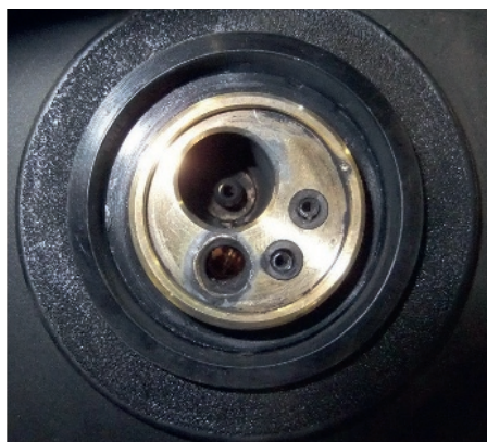
Bild 1. Maschinenseitige (links) und brennerseitige Schmorstellen im Zentralanschluss (rechts; alle Bilder: D. Springhardt, Bergheim)
