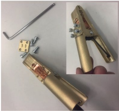
Bild 5. Messingklemmen haben im Vergleich zu Stahlblechklemmen eine deutlich höhere elektrische Strom- und Wärmeleitfähigkeit.
