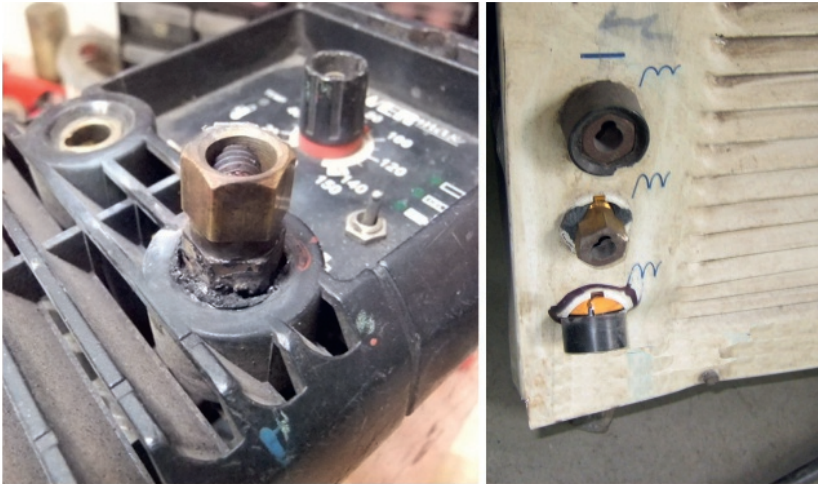
Bild 2. Mit der Buchse in der Schweißstromquelle verschmolzener Steckkontakt (links) und beschädigte maschinenseitige Anschlussbuchsen der Werkstückleitung (rechts).
