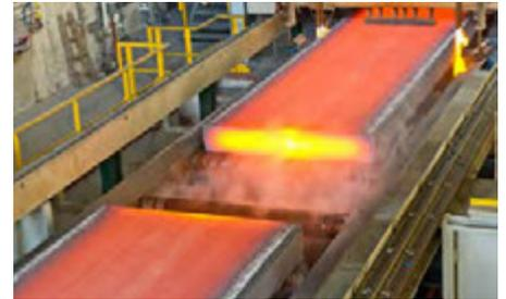
**Einsträngige Brammenstranggießanlage von Primetals Technologies** (Foto: Primetals Technologies)
