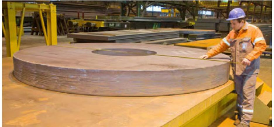
**Großes, schweres Ringsegment mit 305 mm Dicke für ein Wasserkraftwerk** (Foto: Dillinger Weiterverarbeitung)
