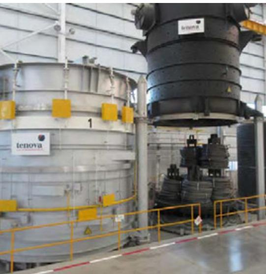
HPH-Haubenglühofen von Tenova LOI für Stahldraht (Foto: Tenova LOI)
