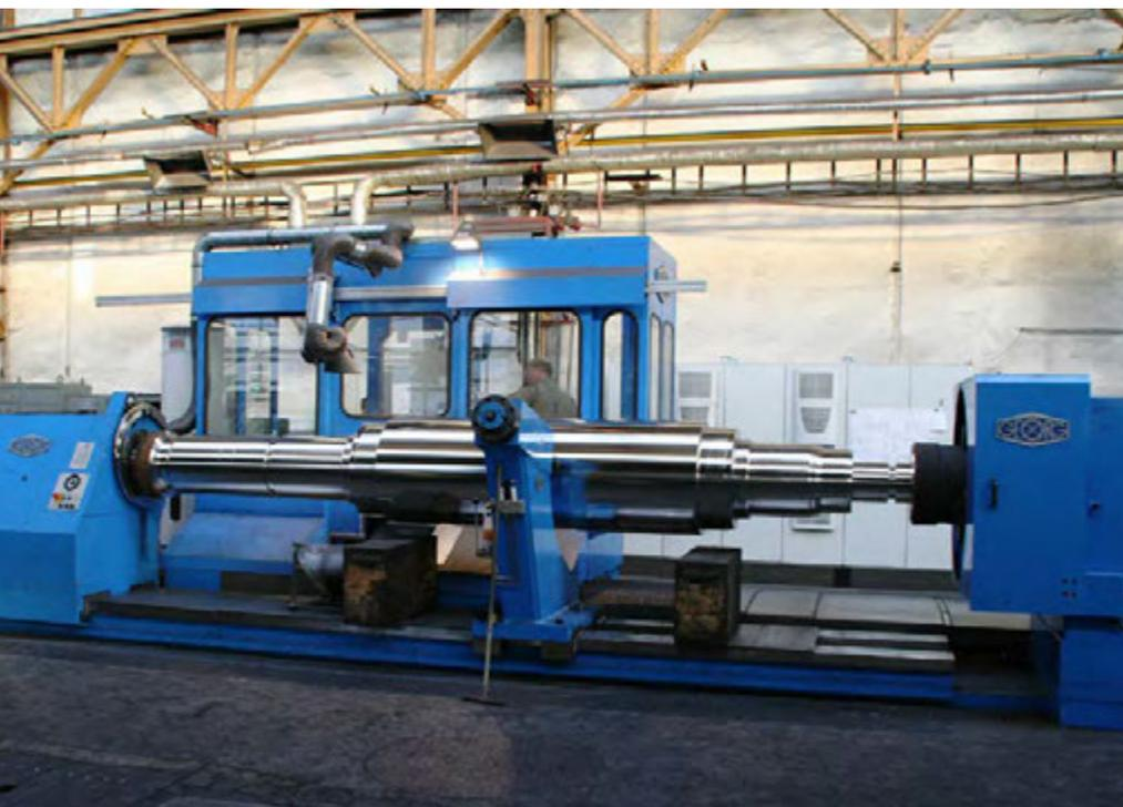
Die neue Walzendrehmaschine ist ausgelegt für bis zu 8.000 mm lange und bis zu 30 t schwere Walzen mit einem Durchmesser von bis zu 1.500 mm. Das Foto zeigt die im Jahr 2013 gelieferte, baugleiche Maschine (Foto: Heinrich Georg Maschinenfabrik)
