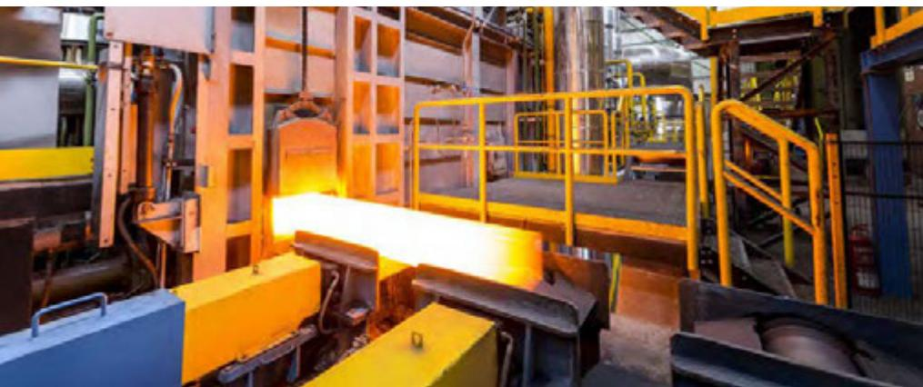
Der SBQ-Hersteller Sidenor Basauri erhöht bei der zweiten Ausbaustufe seines Hubbalkenofens die Ofenkapazität von heute 85 t/h auf 130 t/h. Der von der SMS group im Jahr 2016 gelieferte Ofen wurde von
