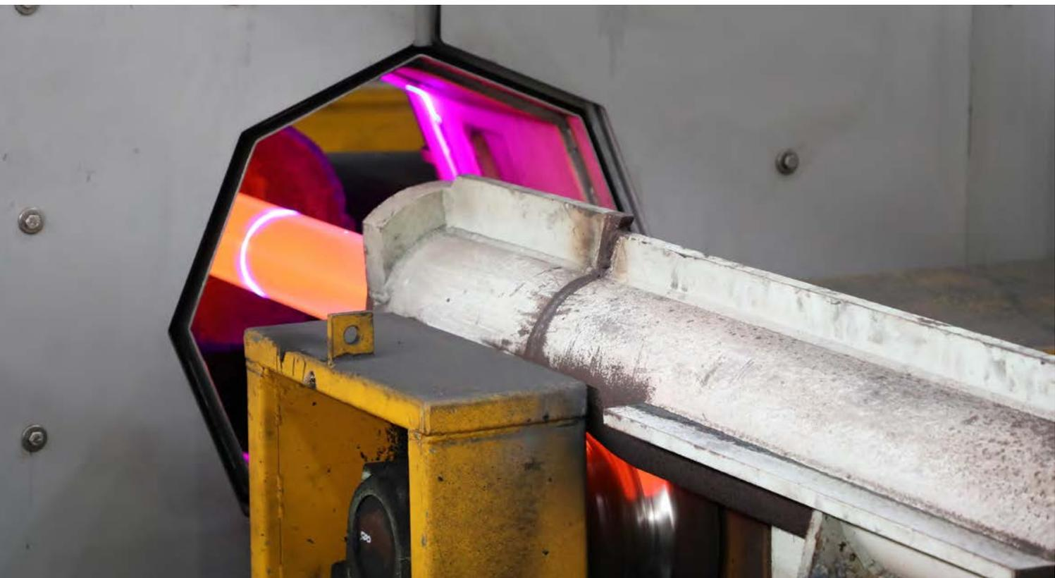
Die Messsysteme von IMS werden zur 360°-Inspektion von Produkten mit unterschiedlichsten geometrischen Eigenschaften eingesetzt (Foto: IMS)
