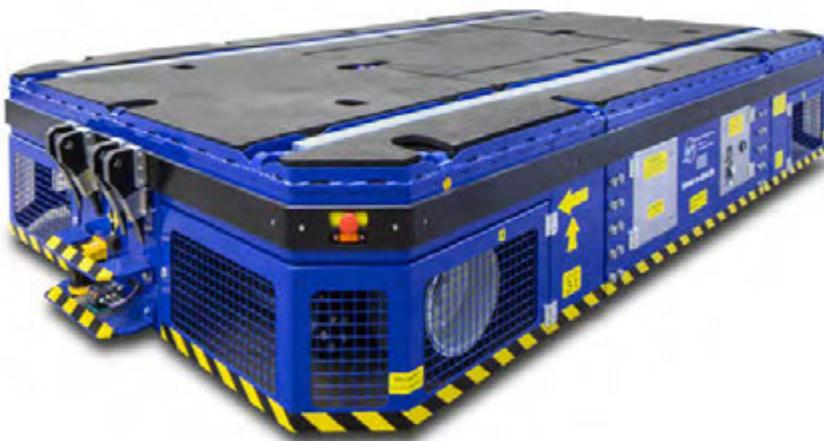
Der „move-e-star“ mit einer Nutzlast von 12 t ist mit Vollgummirädern ausgestattet und erlaubt somit auch den Einsatz auf Asphalt oder Schotter (Foto: HIT Hafen- und Industrietechnik)
