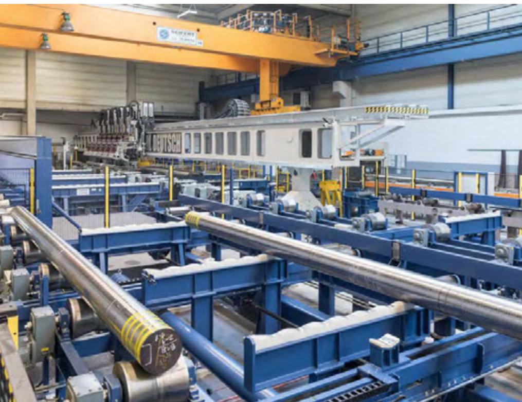
**Bild 8. Moderne Ultraschallprüfanlage für Stabstahl** (Foto: BGH Edelstahl Siegen)
