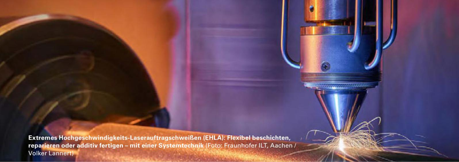
Extremes Hochgeschwindigkeits-Laserauftragschweißen (EHLA): Flexibel beschichten, reparieren oder additiv fertigen – mit einer Systemtechnik (Foto: Fraunhofer ILT, Aachen / Volker Lannert)
