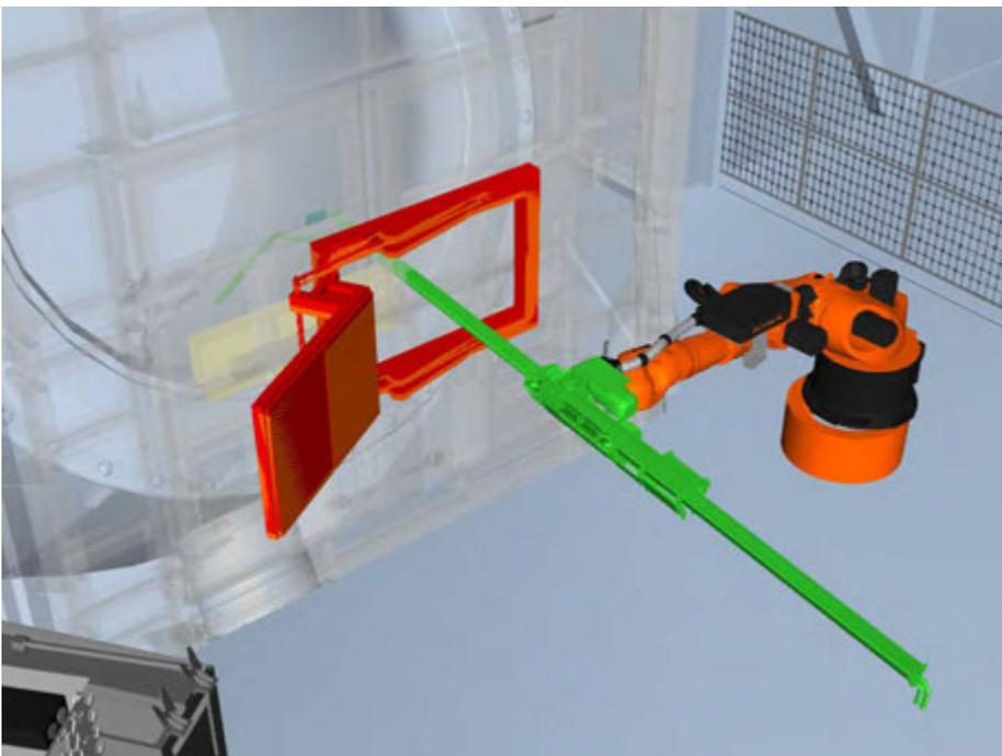
**Bild 1. Roboter positioniert horizontales Messwerkzeug an einem LD-(BOF-)Konverter**
