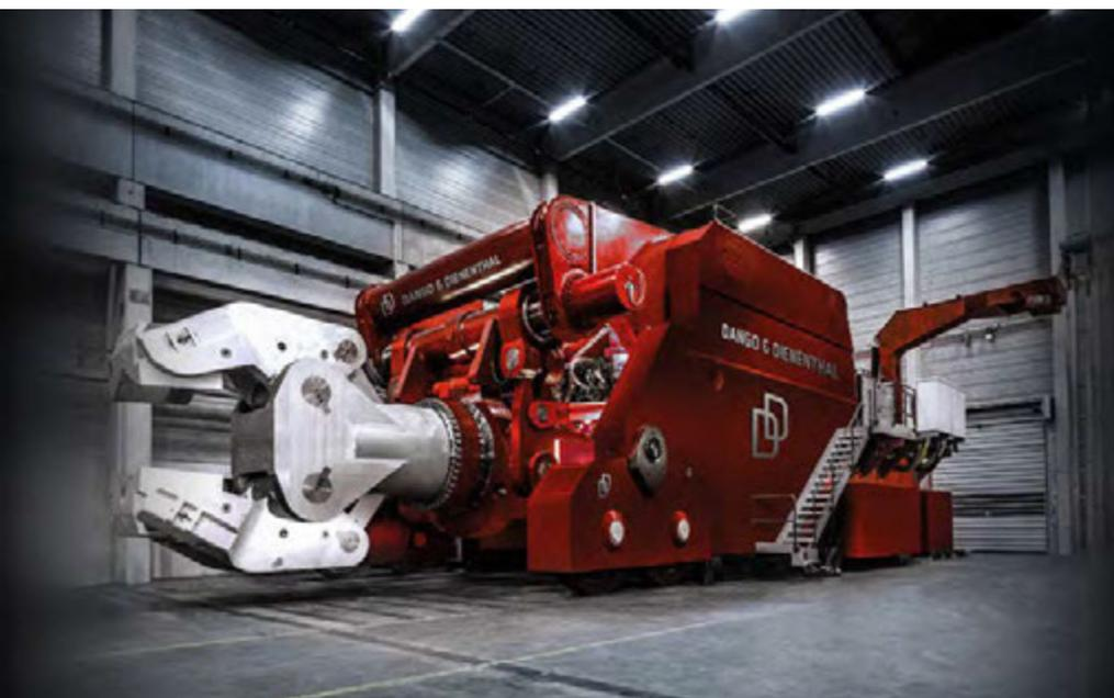
Die Schmiedemanipulatoren vom Typ SSM liefert Dango & Dienenthal ab sofort mit dem ERS-System zur Energie-Rückgewinnung (Foto: Werksfoto Dango & Dienenthal Maschinenbau)
