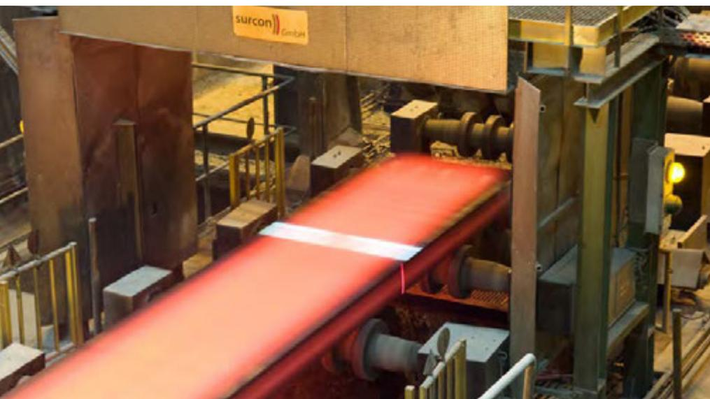
In einem Arbeitsgang und unter härtesten Bedingungen werden Dimensionen, Konturen und Geradheit präzise gemessen sowie Oberflächenfehler wie Risse, Ablagerungen, Einschlüsse oder Vertiefungen zuverlässig erkannt (Foto: IMS)
