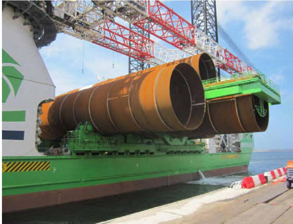
**Grobblech von Dillinger sorgt beim Windpark Rentel für stabile Monopile-Fundamente**
