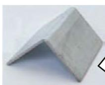
Biegen bis zum Anriss bei einer Schenkellänge von 30 mm Dualphasenstahl (herkömmlich) ohne garantierten Biegewinkel
