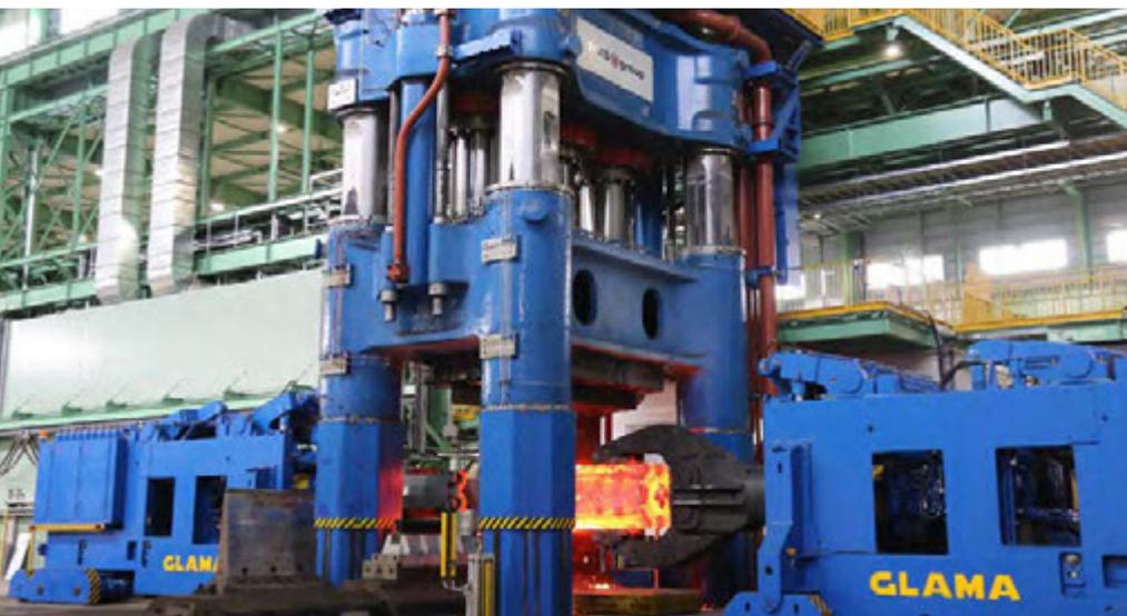
Hitachi Metals, Yasugi, hat der SMS group nach erfolgreicher Inbetriebnahme der 90/108-MN-Freiformschmiedepresse das FAC (Final Acceptance Certificate) erteilt. Dies ist die größte Vier-Säulen-Freiformschmiedepresse in Oberflurbauweise, die SMS group seit 25 Jahren gebaut hat. Die Anlage arbeitet mit einer Schmiedekraft bis zu 90 MN und einer Stauchkraft von 108 MN. Die Presse
