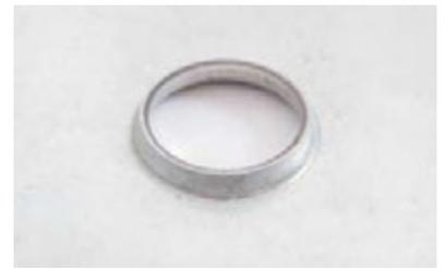
Kragenziehen von 14,4 mm auf 20,0 mm Dualphasenstahl (herkömmlich) ohne garantierte Lochaufweitung
