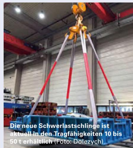
Die neue Schwerlastschlinge ist aktuell in den Tragfähigkeiten 10 bis 50 t erhältlich (Foto: Dolezych)
