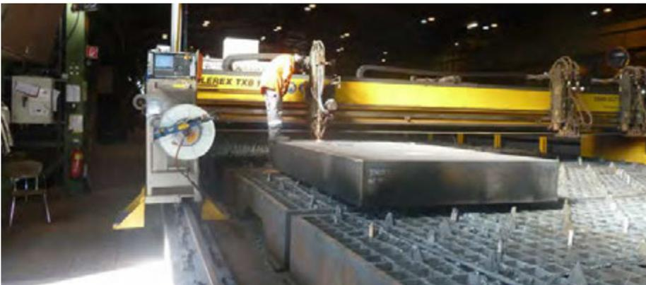
Thermisches Schneiden bis 430 mm Blechdicke und 45 t Stückgewicht (Foto: Dillinger Weiterverarbeitung)
