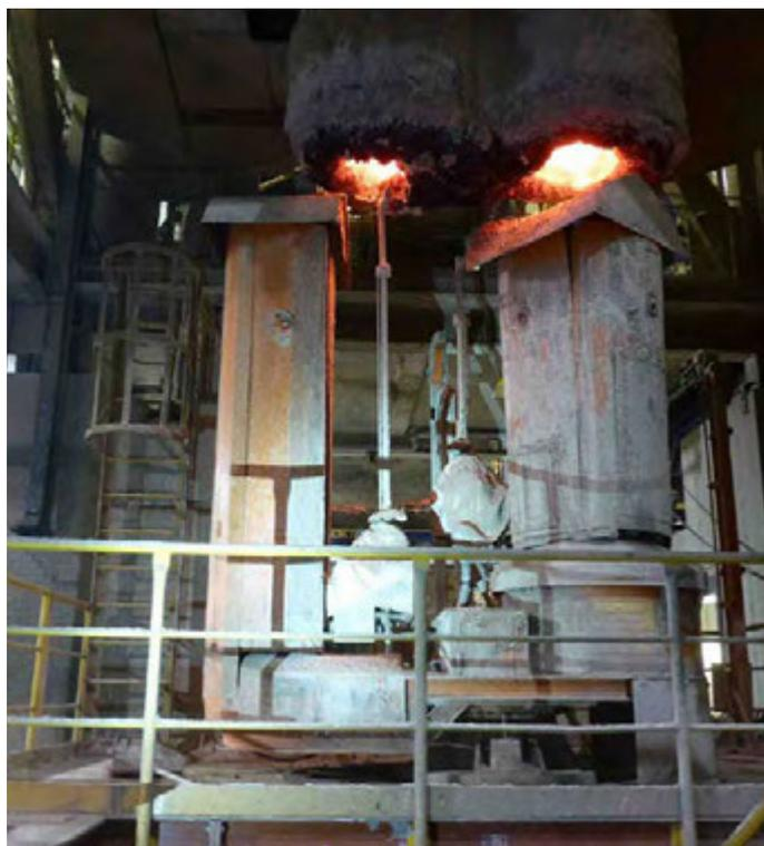
Bei Salzgitter Flachstahl kann der Tauchrohrpflegewagen in beiden RH-Anlagen genutzt werden. Auf ihm befinden sich der Spritzmanipulator mit zwei Lanzen und eine Spritzmaschine mit zwei Ausgängen (Fotos: Velco)
