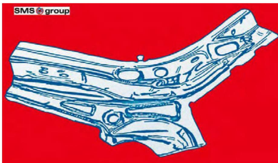
**Bild 12. Die Materialsubstitutionsmöglichkeit vom „Einphasenstahl“ (HC340LAD) zum Dualphasenstahl (HCT600XD) bei einer A-Säulen-Verstärkung kann bis zu 17 % des Bauteilgewichts einsparen [15]**
