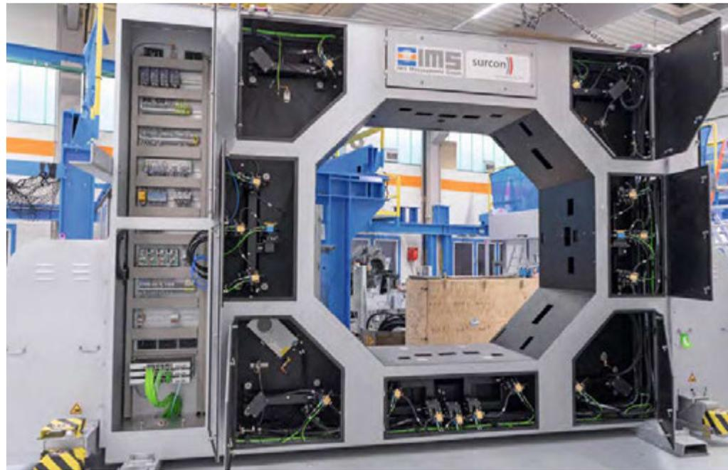
Das Messsystem X-3Dvision von IMS Messsysteme kann Langgutprofile und Rohre in einem Arbeitsgang und unter härtesten Bedingungen auf ihre Dimensionen, auf ihre Kontur und Geradheit sowie auf Oberflächenfehler wie Risse, Ablagerungen, Einschlüsse oder Vertiefungen prüfen (Foto: IMS)
