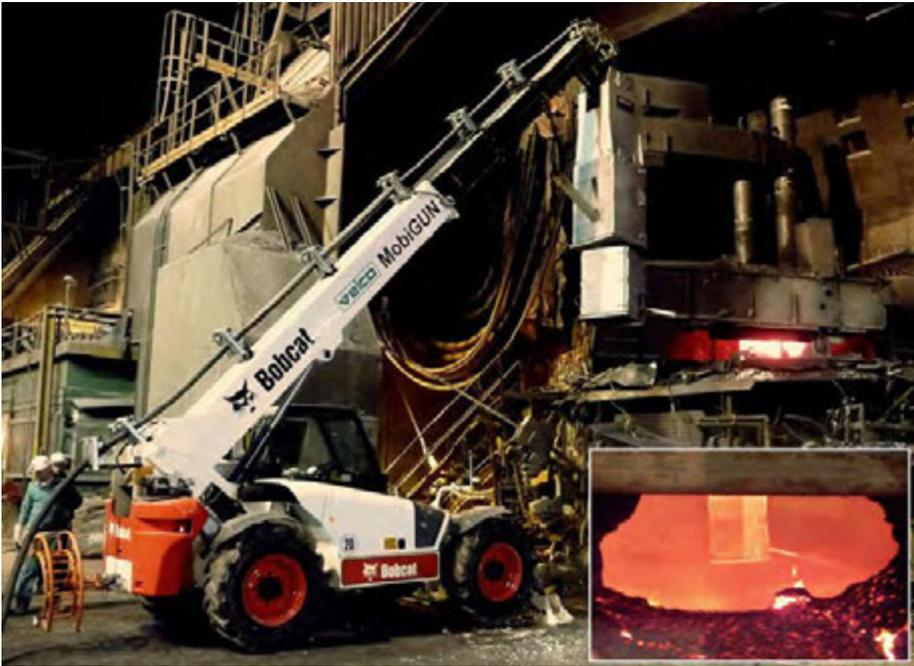
Der Spritzmanipulator kann für alle Öfen verwendet werden, da er eigenständig verfahrbar ist oder mittels Kran bewegt werden kann (Foto: Velco)
