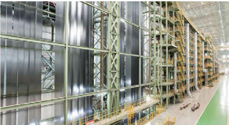
Durchlaufglühanlage (CAL) einer kontinuierlichen Feuerverzinkungsanlage (CGL)
