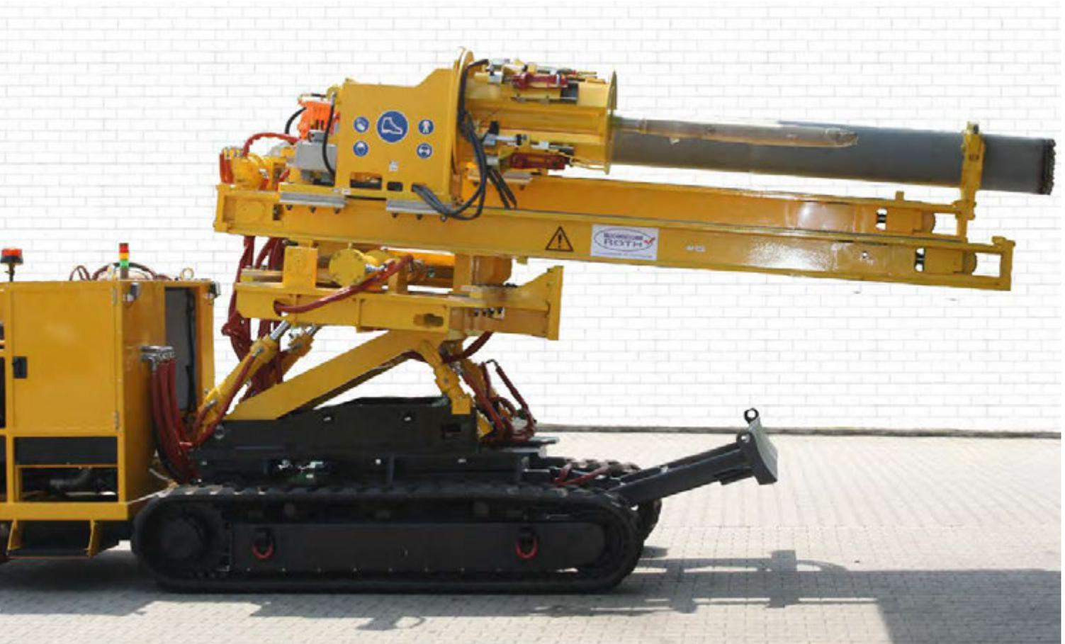
**Bild 3. Weltneuheit made in Germany: Die Kernloch-Bohr-, Setz- und Einschlämmanlage vereinigt vier Arbeitsschritte in einer Maschine** (Foto: Maschinentechnik Roth)
