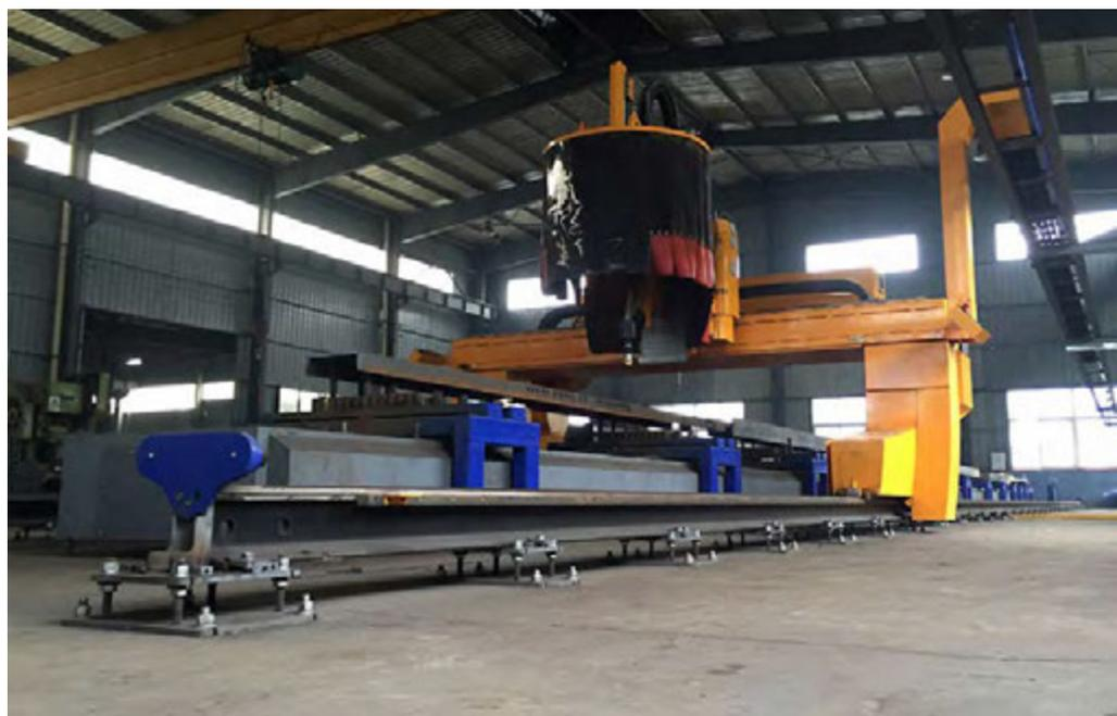
Profilschneidanlage zur Bearbeitung von Werkstücken bis 900 mm Kantenlänge auf einer Bearbeitungslänge von 24 m (Foto: MicroStep Europa)
